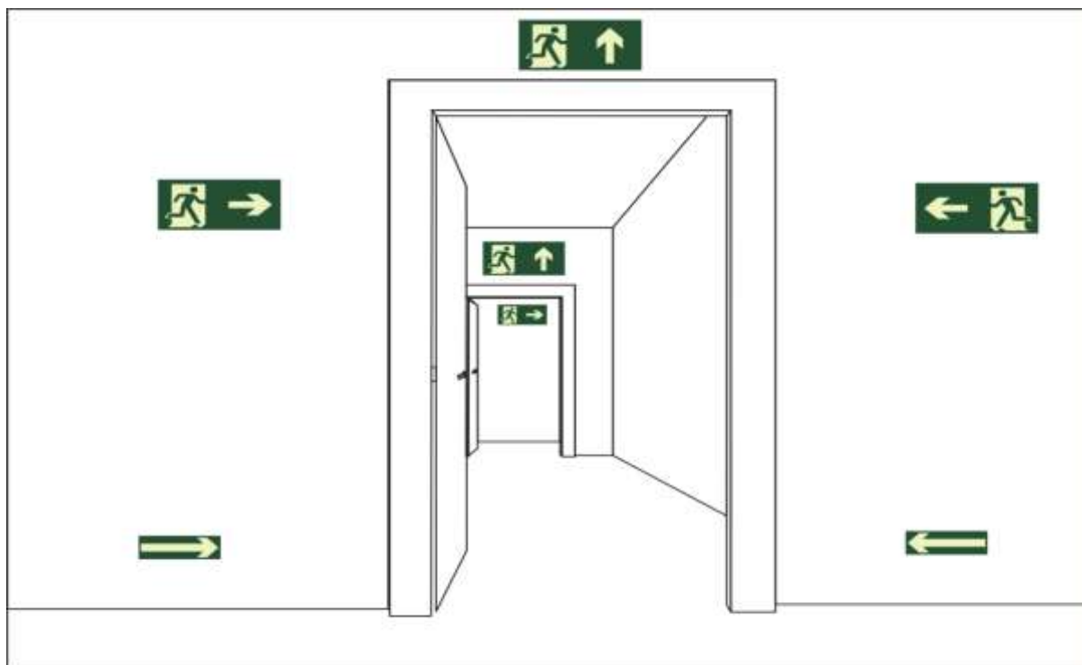
Figura 11 – Sinalização de saída sobre paredes e vergas de portas
